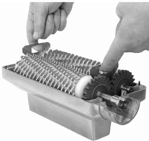
Rys. 9 Demontaż zespołu wałków
